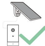
Zajištění, aby napájecí kabel ležel přirozeně bez napětí
